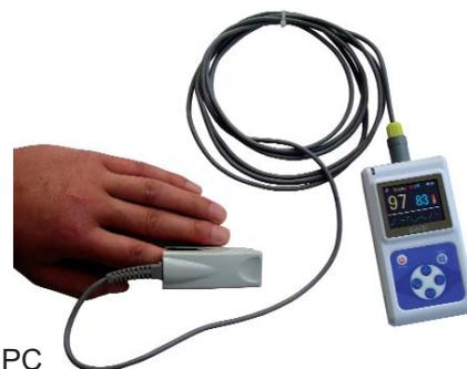
L'oxymètre OXYPAD SENSORS est destiné à la surveillance de routine et en continu de la saturation artérielle en oxygène et de la fréquence cardiaque.
